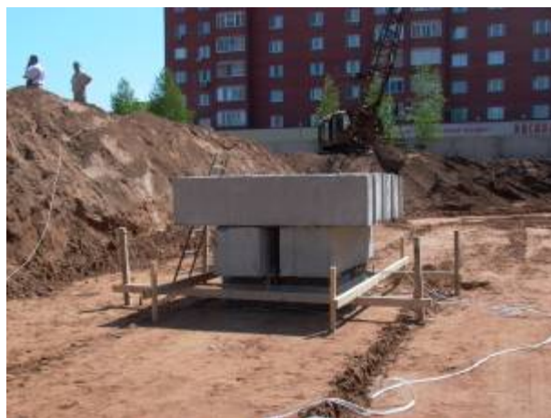
Рис. 4. Штамп площадью 22500 см 2 и нагружение штампа весом фундаментных блоков.
