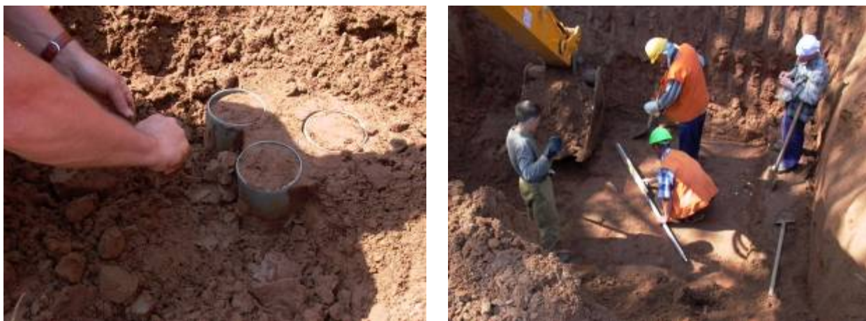
Рис. 6. Отбор монолитов супеси. Штамп номер 3 и подготовка дна выработки перед установкой штампа
