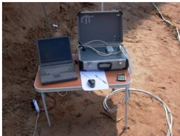
Рис. 5. Датчик перемещений и его крепление к реперной системе и блок регистрирующей аппаратуры с компьютером
