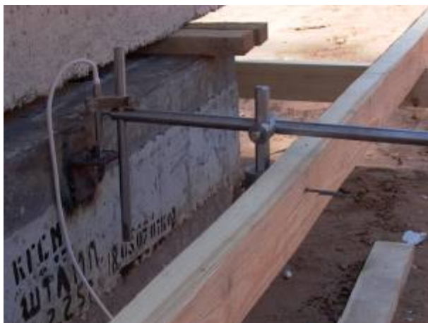
Рис. 5. Датчик перемещений и его крепление к реперной системе и блок регистрирующей аппаратуры с компьютером
