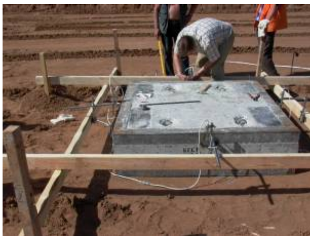
Рис. 4. Штамп площадью 22500 см 2 и нагружение штампа весом фундаментных блоков.
