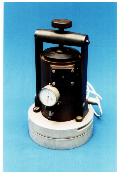
Рис.1. Компрессионный прибор с измерением боковых напряжений
